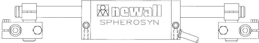
Montage extérieur des supports d'échelle
